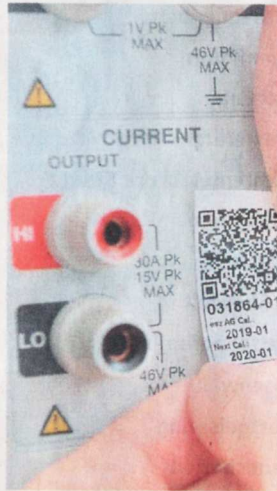
Das Siegel zeigt, wann das Gerät kalibriert wurde.
