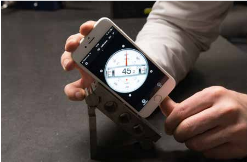
Bild 1. Das Smartphone wird an das Sinuslineal gehalten. (© esz AG)
