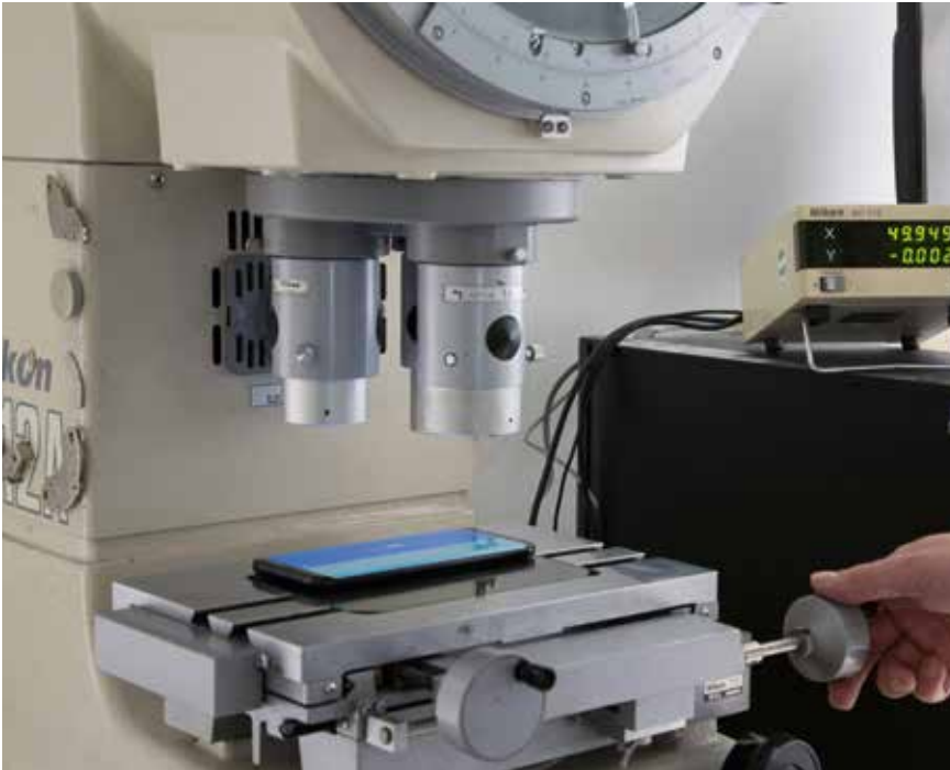
Bild 2. Das Smartphone wird horizontal unter dem Koordinatenmessgerät ausgerichtet. (© esz)
