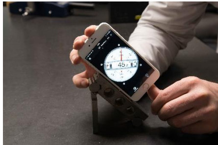
Das Smartphone wird an das Sinuslineal gehalten.
