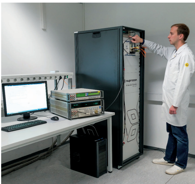
Bild 1. Josephson-Quantenkalibrator: Derzeit kann man Gleichspannung nicht präziser messen. (© esz AG, www.esz-ag.de )
